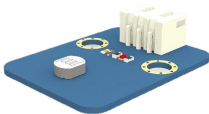
光敏传感器是对外界光信号或光辐射有响应或转换功能的敏感装置，可将光信号转换为电信号。
